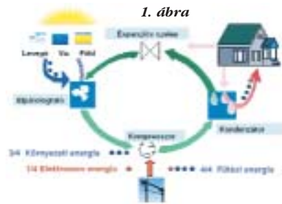
Kompresszoros hőszivattyús rendszer
